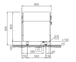
El = Electrical inlet (power) Equipotential screw
